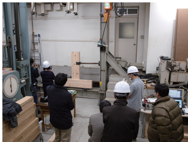
写真-5 木質構造要素の実大検証実験
