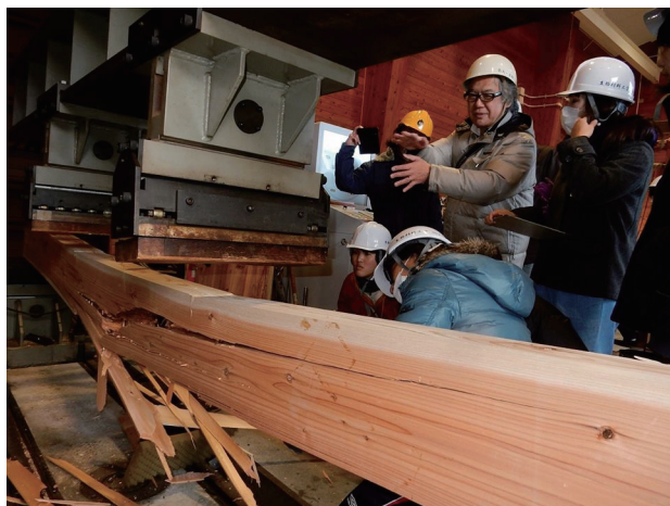
写真-4 地域産木材の強度性能実験実習
