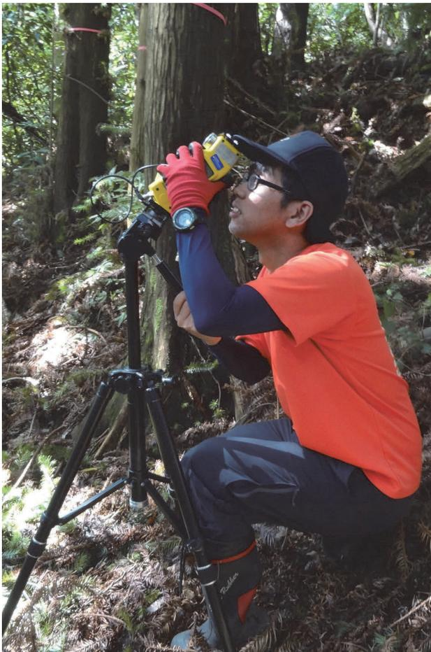
写真-6 クライテリオン RD1000 による樹幹形状の測定。森林総合研究所林木育種センター九州育種場提供。
