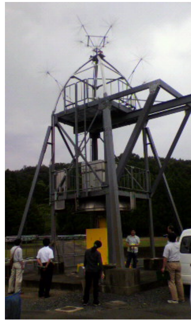
写真-1 ガンマーフィールドの中心に設置されているコバルト60の照射塔
