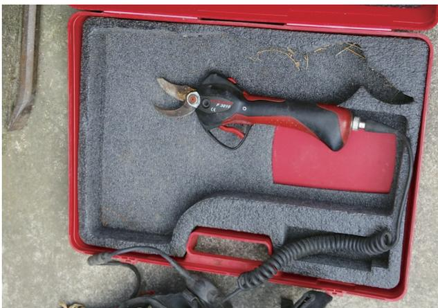
写真-3 自動剪定鋏 F3010。Electro-coup 製。
