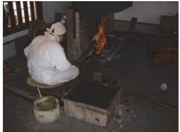
写真-2 瀬戸内市備前長船刀剣博物館における松炭を使用した鍛刀
