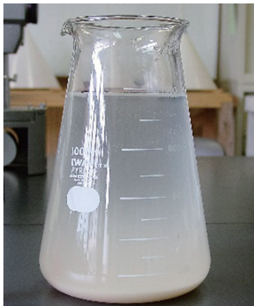
図-5 懸濁液の下部にマツノザイセンチュウが沈殿していく様子
